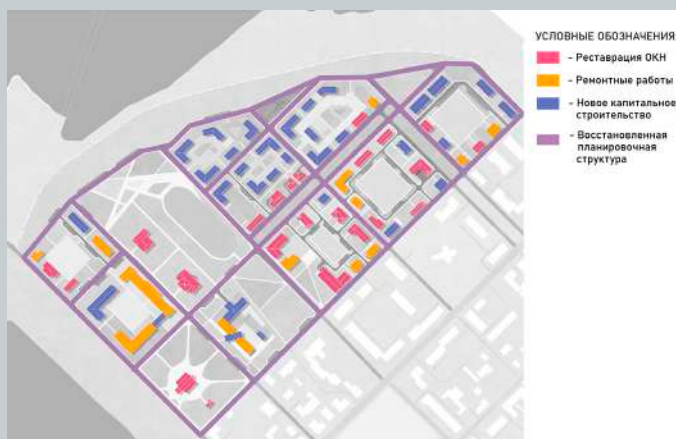
Рис. 2. Схема ремонтно-реставрационных работ
